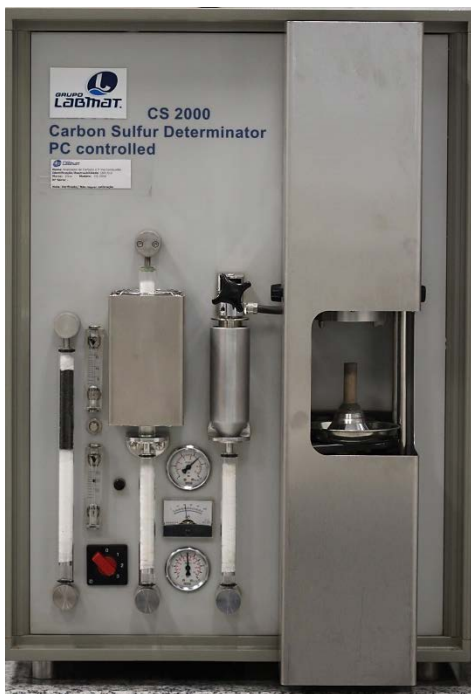
Figura 9: Máquina Eltra CS 2000, utilizada para a Análise de gases e determinação dos elementos C e S
