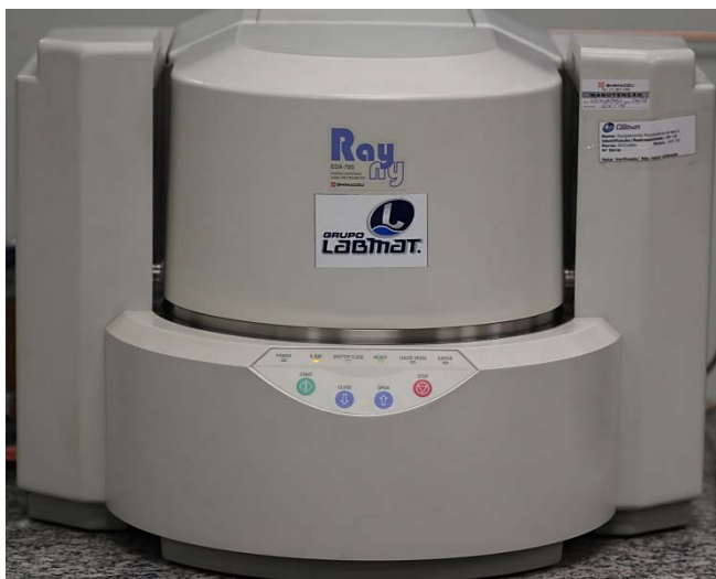
Figura 10: Máquina EDX-720 para análise de espectrometria por energia dispersiva de raios-X (EDX)
