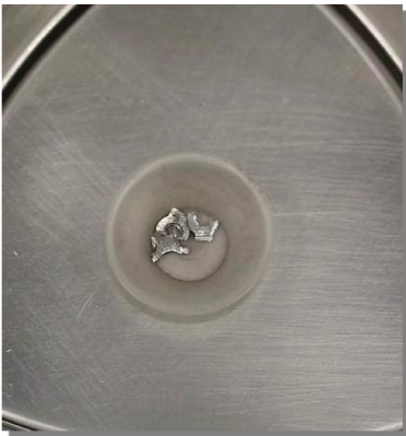
Figura 5: A. Segmentação da amostra a ser submetida à análise de gases.
