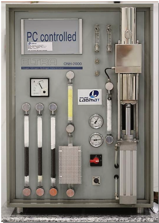
Figura 7: Máquina Eltra ONH 2000, utilizada para a Análise de gases e determinação dos elementos O, N e H
