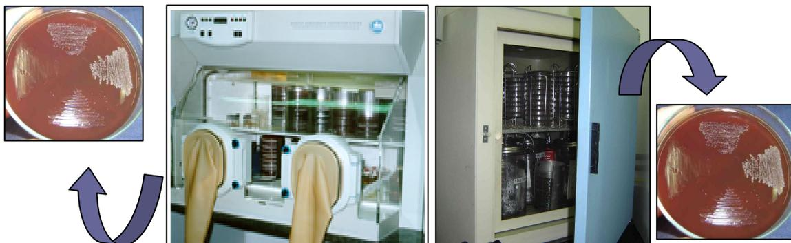
**Figura 5.** Requerimento gasoso utilizando a câmara de anaerobiose (A) e a estufa de  $CO_2$  (B).
