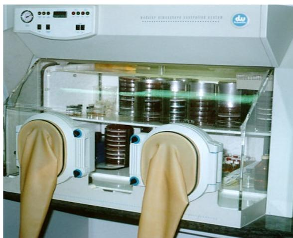
**Figura:** Câmara de anaerobiose
