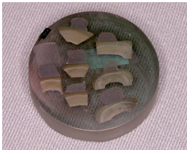
FIGURA 16 – Corte incluídos em resina epóxica, para a análise da interface esmalte/adensivo.
