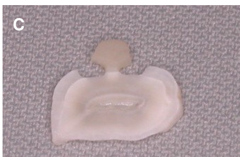
FIGURA 11 – Confecção das amostras do tipo Hour- Glass. A – secção sem a constrição; B – Confecção da constrição com um ponta diamantada ultrafina; C – Constrição confeccionada.
