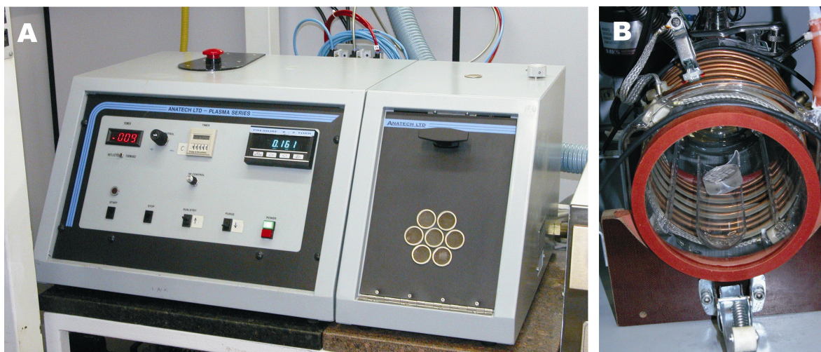
FIGURA 15– A - Aparelho de Plasma de Argônio; B – Câmara de Vácuo para bombardeio com plasma de Argônio.
