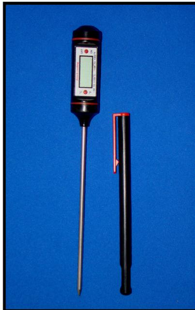
**Fig. 8 – Termômetro utilizado para verificar temperatura do líquido revelador**
