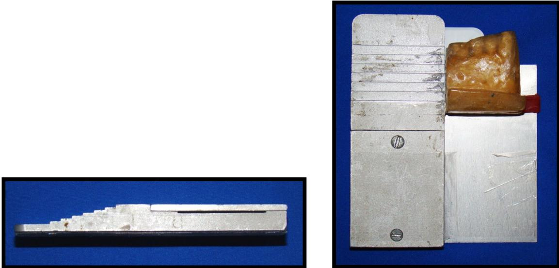
**Fig. 1 – A-) Escala de densidade; B-) *Phantoma* montado para obtenção das imagens radiográficas.**
