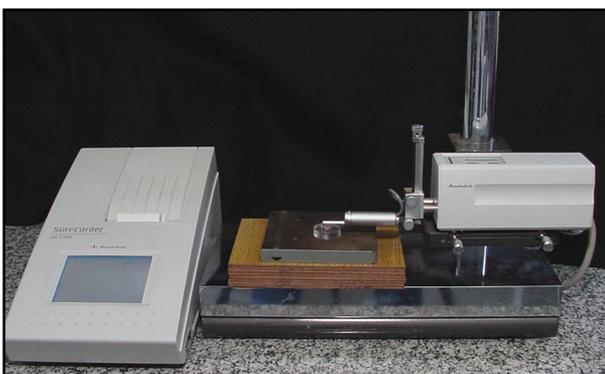
Figura 10 – Rugosímetro Surfscorder SE 1700 utilizado no estudo.
