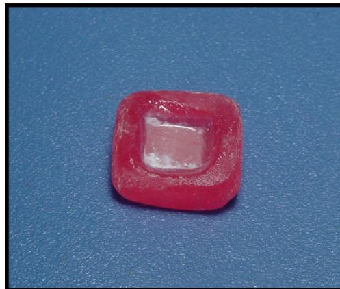
Figura 16 – Biofilme formado sobre a superfície superior do corpo de prova.
