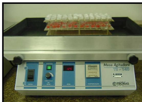
Figura 18 - Tubos de ensaio em agitação em Mesa Agitadora TE – 140.
