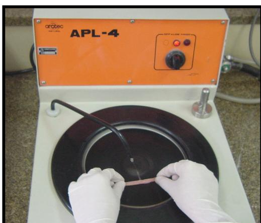
Figura 8 - Acabamento das amostras em resina acrílica realizado em politriz APL-4 (AROTEC).
