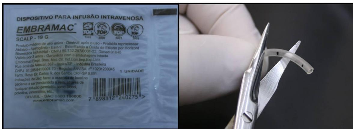
**Figura 1** – Confecção dos corpos de prova com tubos de polietileno
