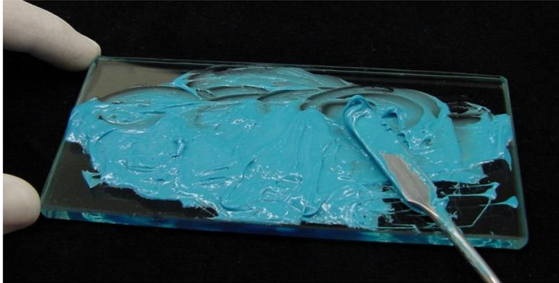
Fig. 4.3.1d – Elite® HD+ (leve) manipulado.
