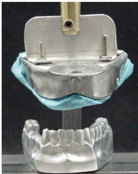
Fig. 4.3.2f – Separação molde/modelo.
