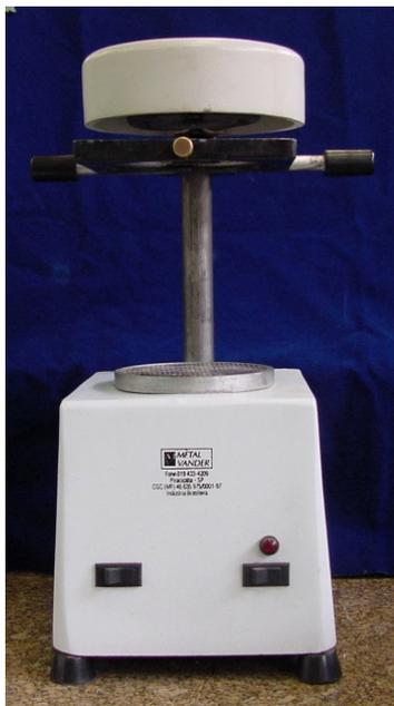
Fig. 4.3.2 – Plastificadora a vácuo.
