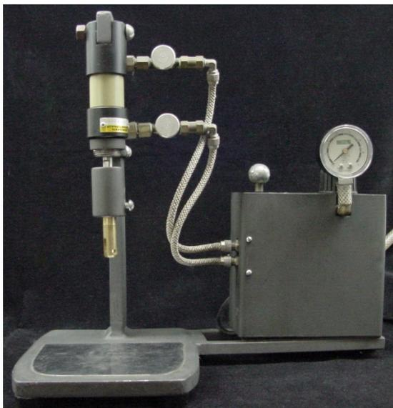
Fig. 4.3.5 – Equipamento pneumático utilizado para a remoção das moldeiras.
