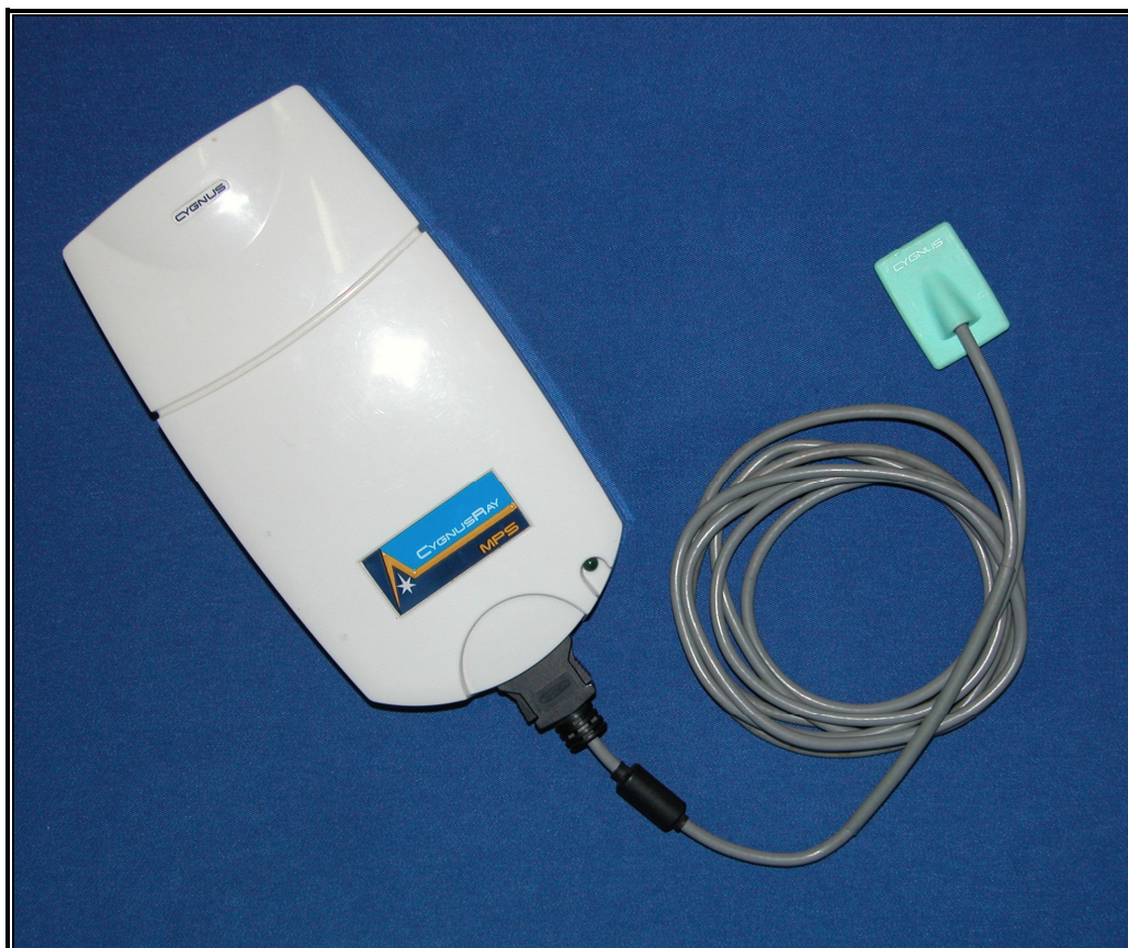
Figura 7: Conversor analógico-digital e receptor de imagem do sistema Cygnus MPS®.
