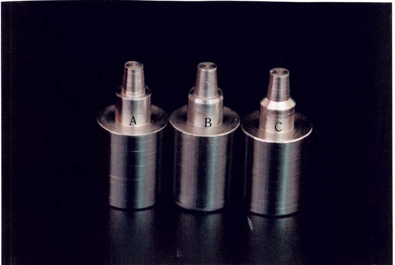
FIGURA 4.2.1 - Fotografia ilustrativa dos troquéis metálicos torneados em aço inoxidável, com terminos cervicais em ombro reto (A); biselado em  $20^{\circ}$  (B); e, chanfro em  $45^{\circ}$  (C).
