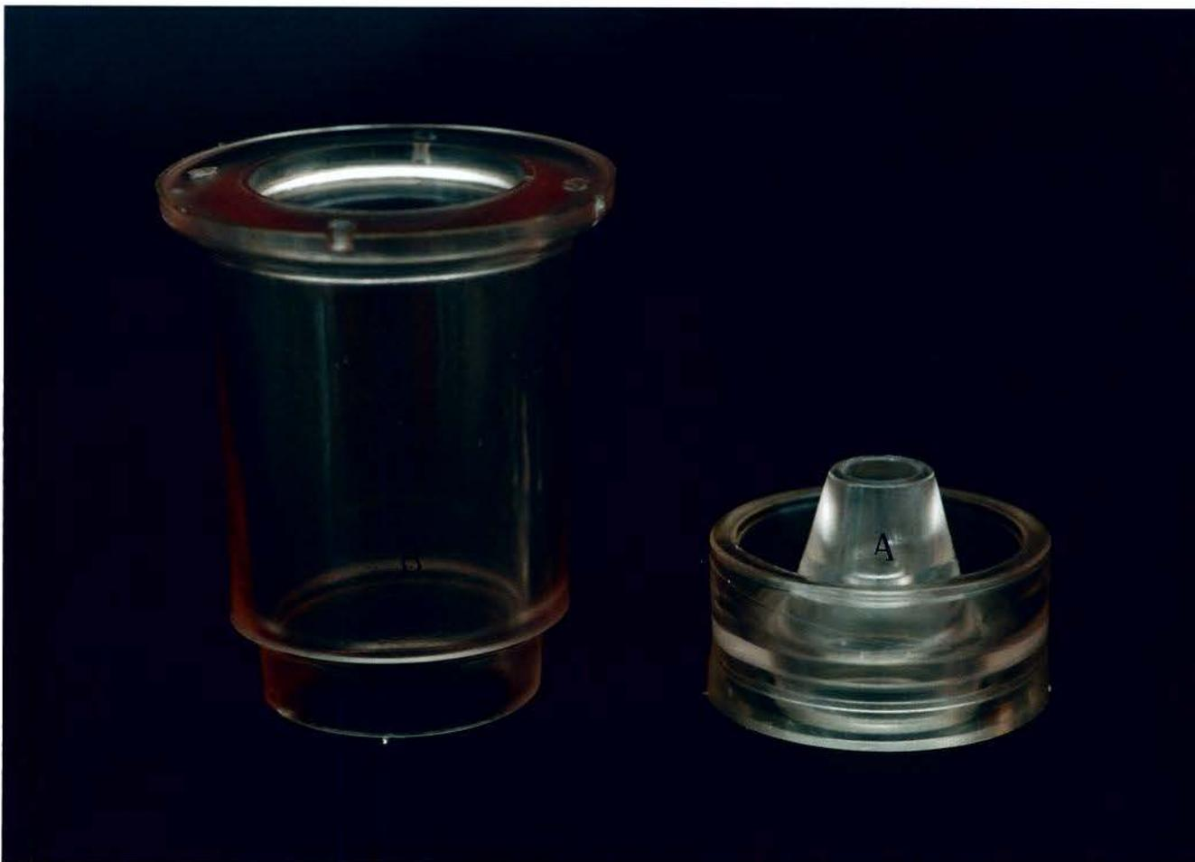
FIGURA 4.2.4 - Fotografia ilustrativa da base formadora do cadinho (A) e do anel de fundição de silicone (B).
