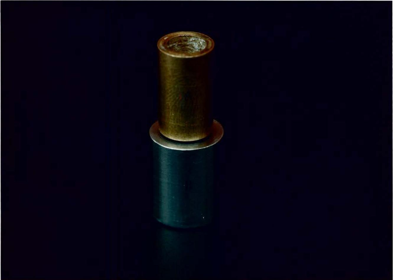
FIGURA 4.2.3 - Fotografia ilustrativa da matriz cilíndrica metálica (A) utilizada para uniformizar a espessura dos padrões de cera, confeccionados no troquel metálico (B).
