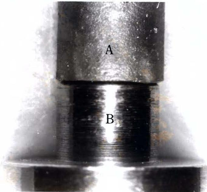
FIGURA 5.14 - Fotografia ilustrativa de um corpo-de-prova da liga à base de Pd/Ag (PORS - ON 4) (A), fundido com a fonte de calor resistência elétrica, posicionado sobre o troquel metálico (B) (8 X no negativo).
