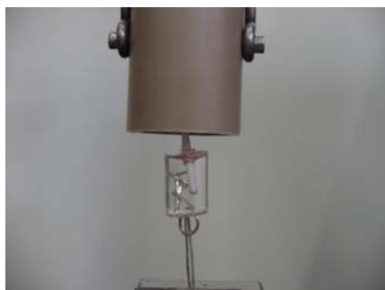
Fig. 16 – Pino sendo tracionado durante ensaio.
