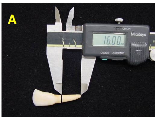
Fig. 3 - A e B - Confirmação da padronização das raízes.
