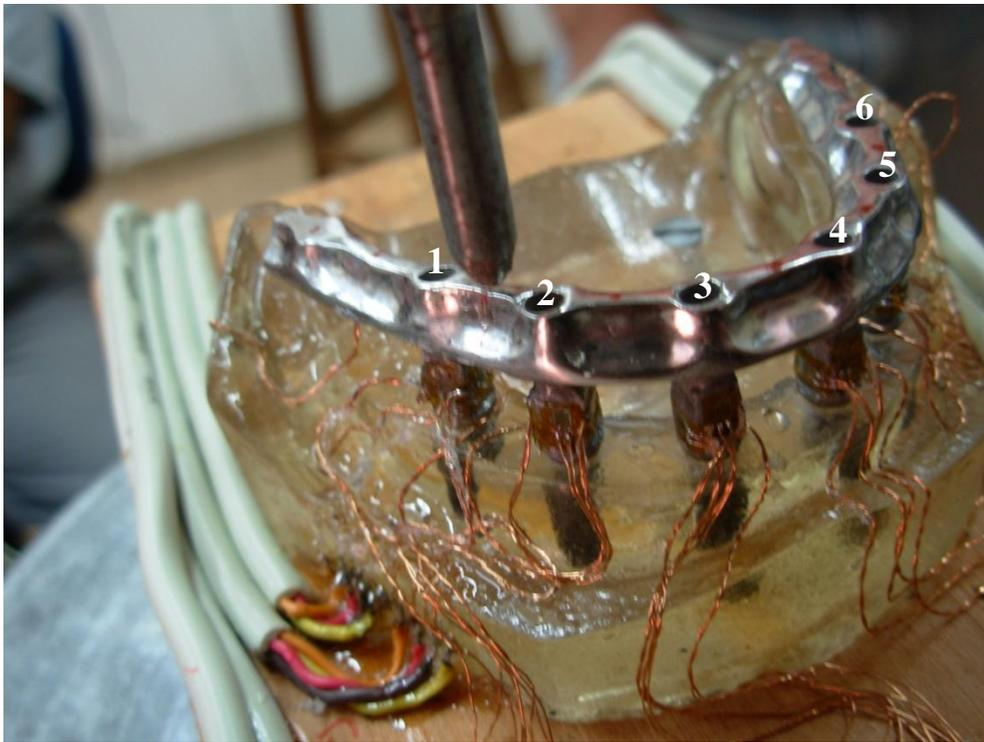
Fig. 13 – Sequência de aperto dos parafusos.
