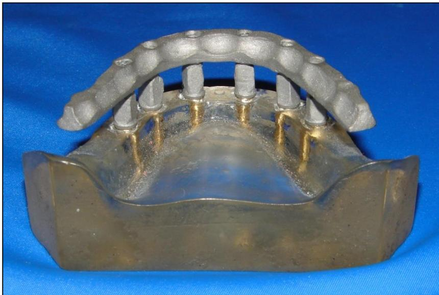
Fig. 6 – Corpo de provas fundido adaptado ao modelo experimental.
