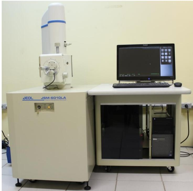
Figura 9: Microscópio eletrônico de varredura-MEV (JEOL, JSM-6010LA-Analytical Scanning Eletron Microscope, Tokyo-Japão).
