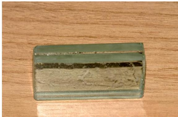
Figura 8 – Matriz de vidro para confecção do corpo-de-prova.
