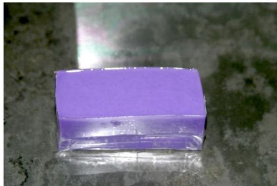
Figura 10 – Caixa de plástico preenchida com silicone.
