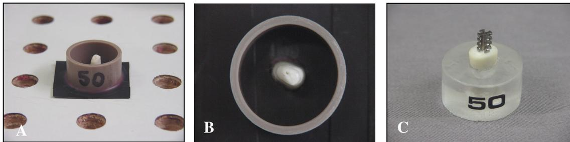
**FIGURA 5** - Raiz posicionada na perfuração de uma tábua com porção apical voltada para cima (A); anel de tubo de PVC fixado com cera sobre a película radiográfica, em cujo interior foi centralizada a raiz (B); corpo-de-prova obtido após polimerização da resina e remoção do anel de PVC (C).
