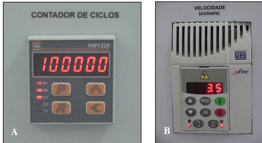
**FIGURA 9** – Visor digital da Máquina de Ciclagem Mecânica, indicando o número de ciclos (A) e a frequência (B) utilizadas no estudo.
