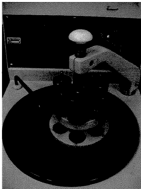
Figura 13 - Politriz horizontal usada no acabamento e polimento das amostras
