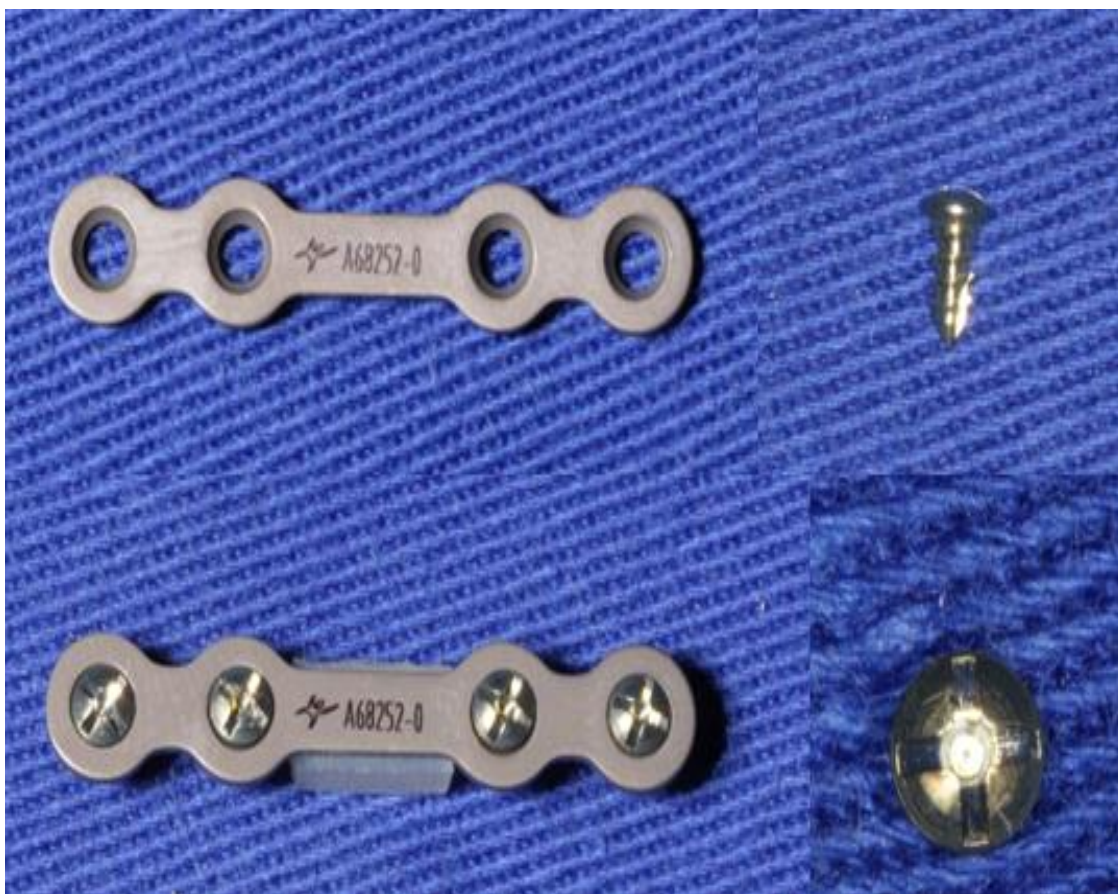
Figura 13. - Imagem das placas, parafusos e chaves usados nas mandíbulas fotoelástica
