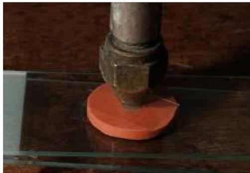
Figura 10 - Escoamento na prensa.
