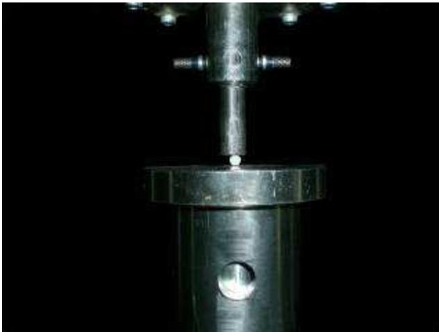
Figura 18 – Ensaio de Compressão Diametral.
