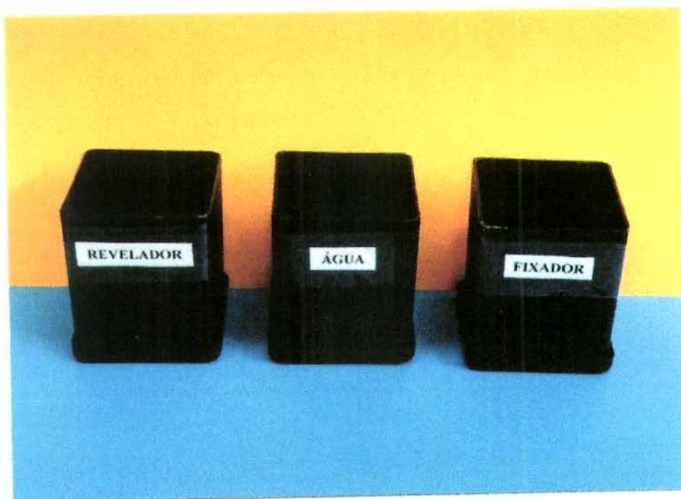
Figura 9 - Recipientes de polietileno (desprotegidos).
