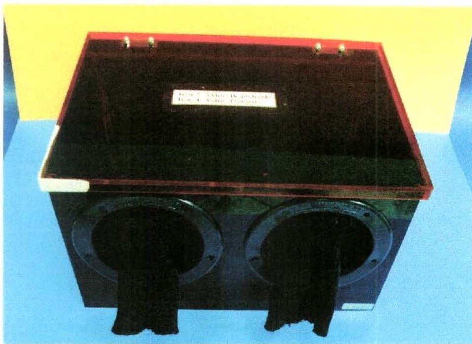
Figura 1 - Câmara portátil para processamento radiográfico (M.P.G.)
