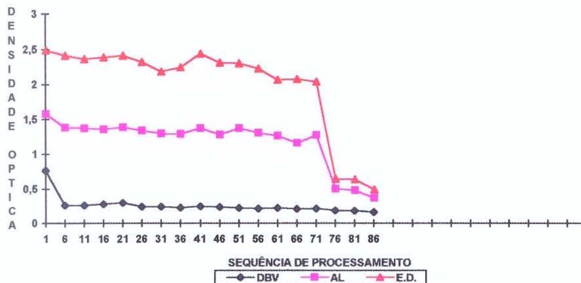
Gráfico 23 - Densidades ópticas resultantes do teste das soluções Kodak, protegidas, em recipientes de vidro, obtidas de radiografias do simulador.
