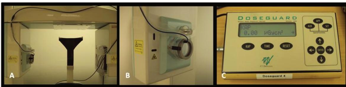
**Figura 11.** (A) Câmara de ionização posicionada na saída do feixe de raios X. (B) Vista aproximada. (C) Eletrômetro para a leitura dos valores de DAP.
