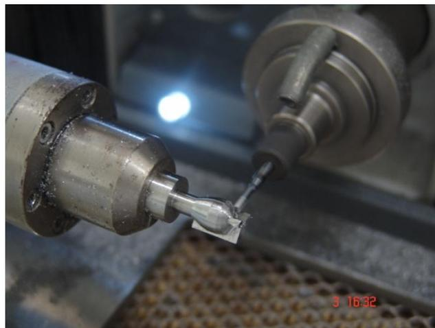
Figura 13 - Unidade CAM usinando cilindro experimental. Grupo teste após fase 1.
