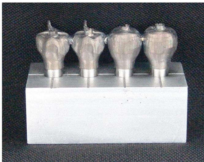
Figura 18 - Infraestrutura fresada após ciclagem de aplicação de cerâmica.
