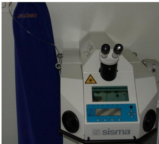
Figura 15 - Equipamento para soldagem à laser Nd-Yag.
