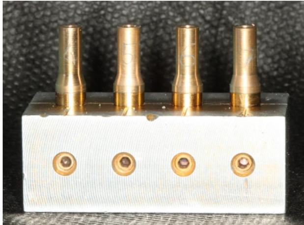
Figura 4 - Cilindros calcináveis banhados com ouro para leitura em MEV, grupo controle após fase 1.
