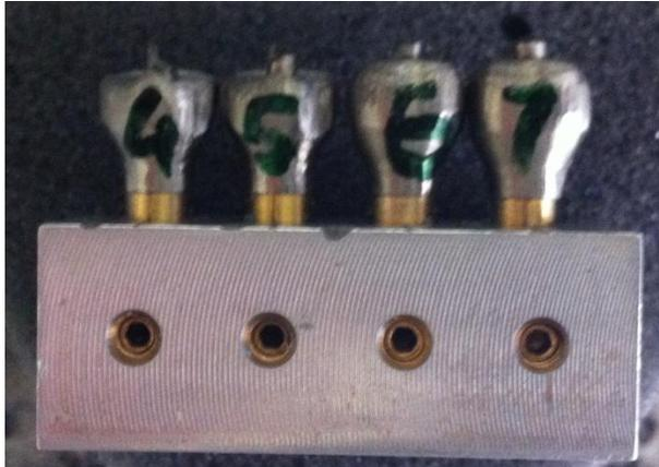
Figura 14 - Cilindros fresados em posição para união com solda à laser. Grupo teste após fase 2.
