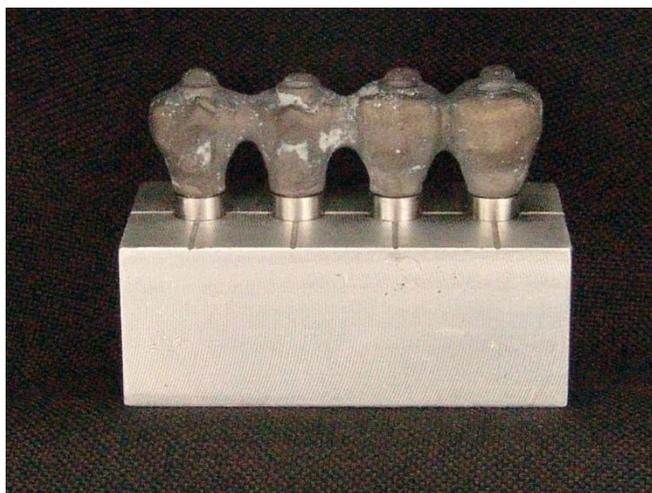
Figura 9 - Infraestruturas fundidas em titânio após ciclagem para aplicação cerâmica, grupo controle após fase 4.
