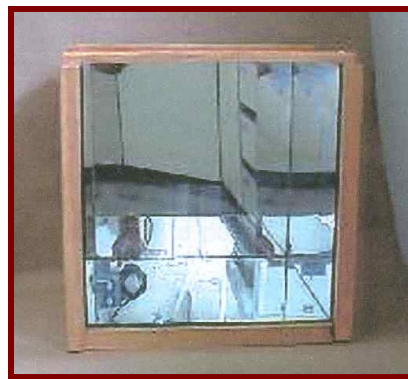
Fig. 4.2 – Câmara de observação (30 cm 3 , laterais fundo e base espelhada e frente em vidro).
