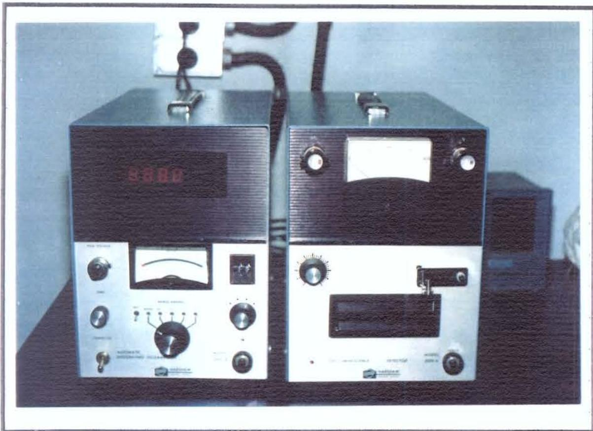
Figura 3: Detector termoluminescente modelo 2000 A e 2000B
