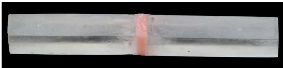
Figura 13 – Corpos-de-prova finalizados para o ensaio de resistência à tração.
