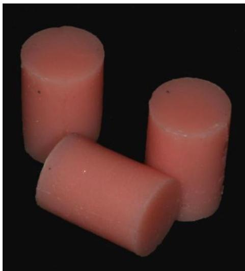
Figura 5 – Corpos-de-prova finalizados para o ensaio de deformação permanente.
