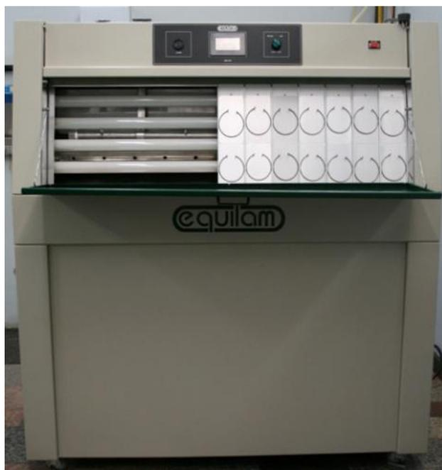
Figura 14 – Equipamento para envelhecimento acelerado Modelo EQ-UV (Equilam).
