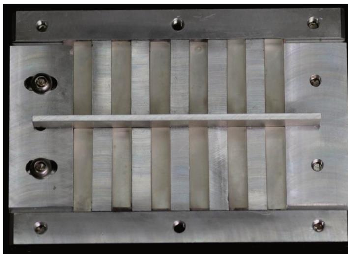
Figura 11 – Matriz metálica (resistência à tração).
