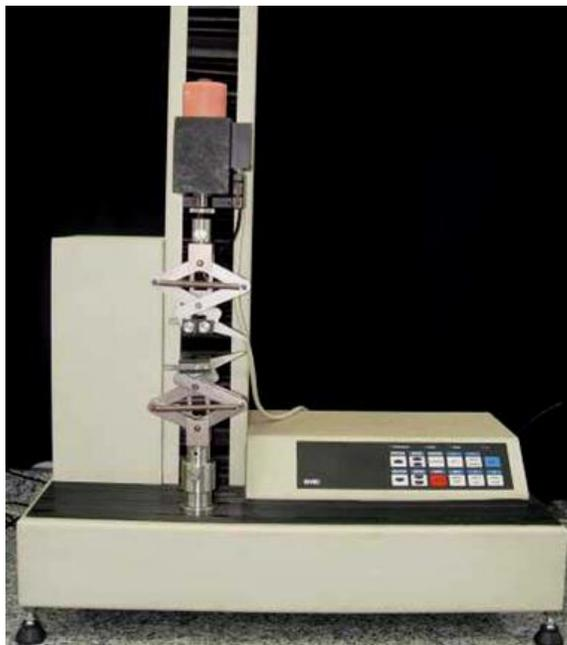
Figura 17 – Máquina de Ensaio - Emic DL-500 MF.
