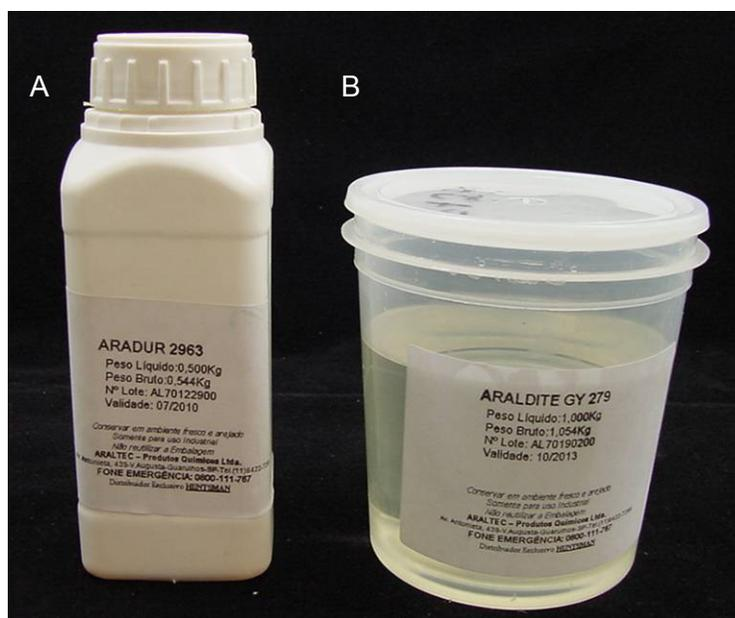
**Figura 4.1** – Endurecedor Aradur 2963 (A) e resina fotoelástica base Araldite GY 279 (B).
