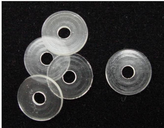
**Figura 4.5** – Discos de resina fotoelástica.
