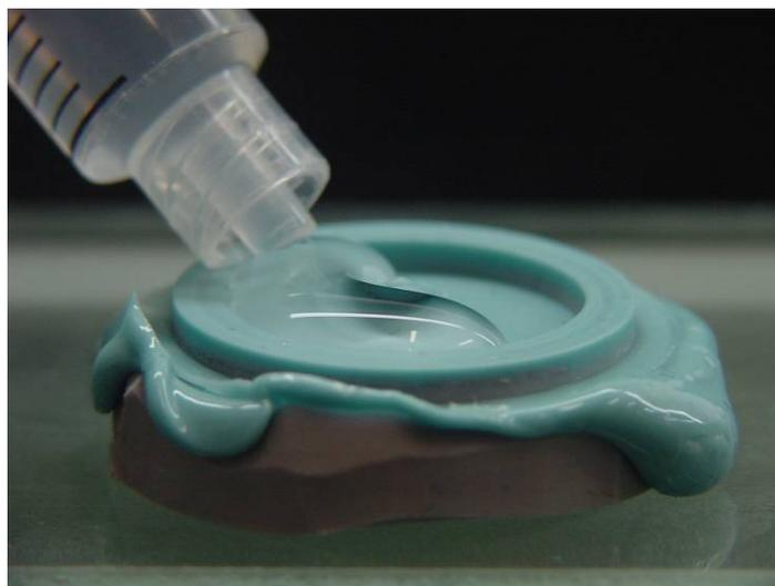
**Figura 4.4** – Inserção da resina fotoelástica no molde.
