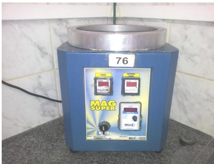
Figura 5. Equipamento para polimento.
