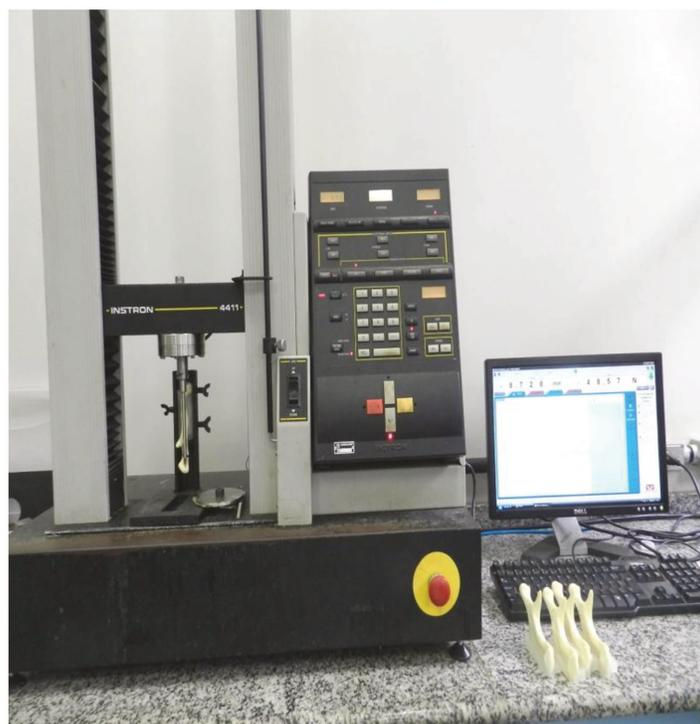
Figura 20. Máquina universal Instron, modelo 4411.
