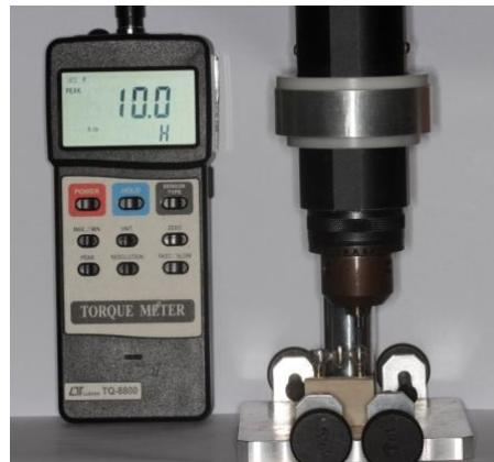
**Figura 9** – Torquímetro digital e dispositivo de posicionamento.
