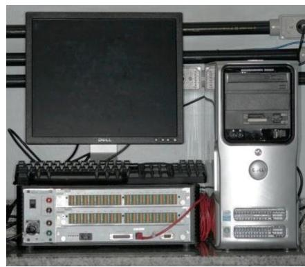
**Figura 14** – Equipamento para análise de tensão - ADS 2000.
