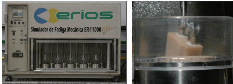
**Figura 11** – Aplicação da carga no Simulador de Fadiga Mecânica – Pilar B (PPF).
