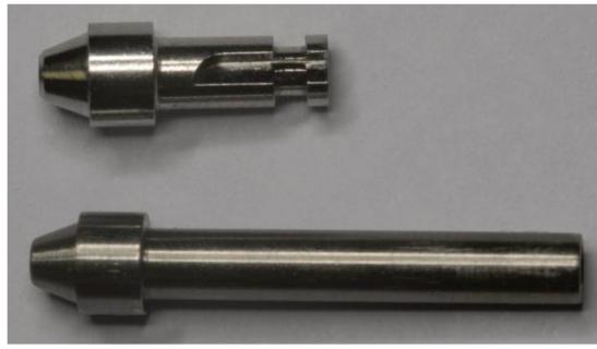
**Figura 7** – Análogo convencional de mini pilar (superior); Análogo modificado de mini pilar (inferior).
