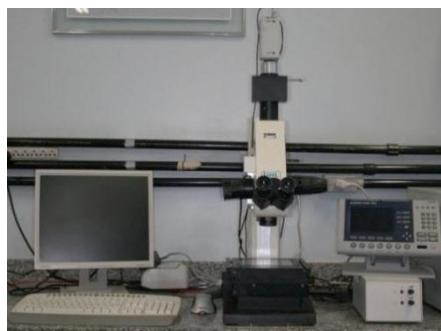
**Figura 10** – Microscópio de aferição e unidade analisadora.
