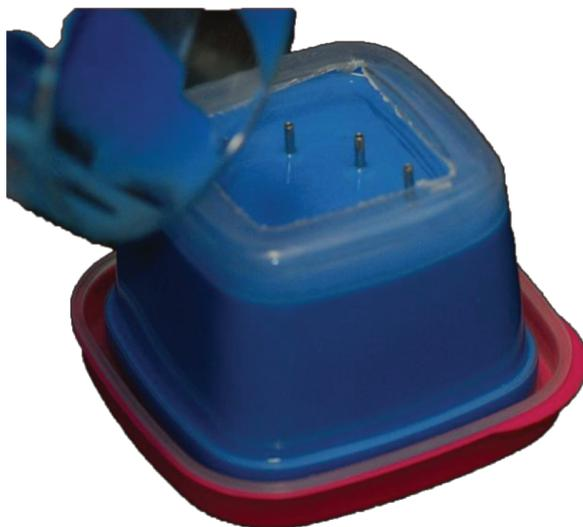
Figura 5. Silicone ASB-10 sendo depositado no interior do recipiente plástico.
