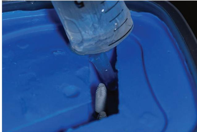
Figura 8. Preenchimento do molde com resina fotoelástica.
