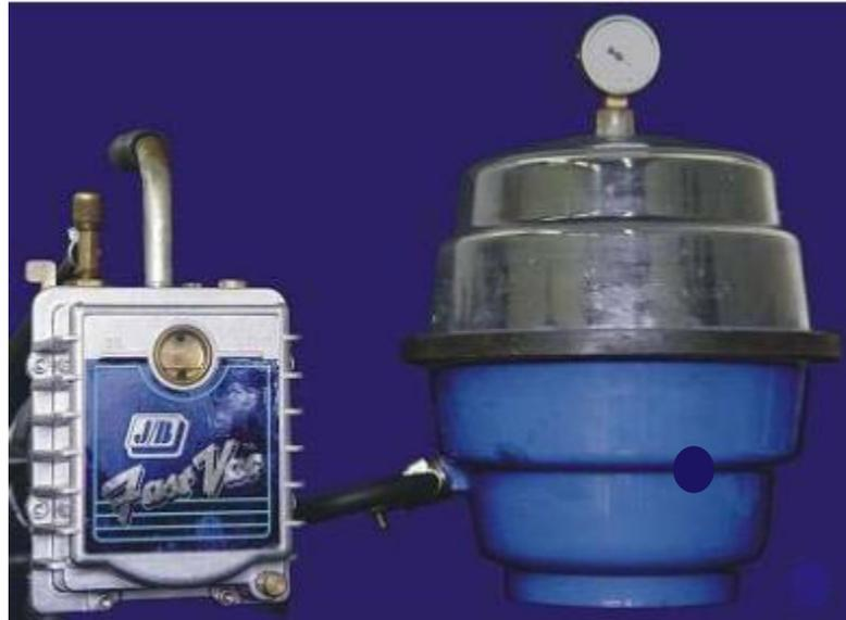
Figura 7. Câmara de pressão à vácuo.
