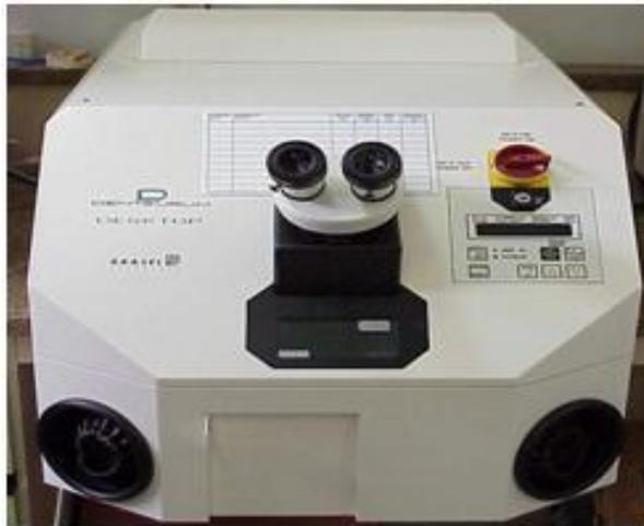
Figura 2. Máquina de solda laser.
