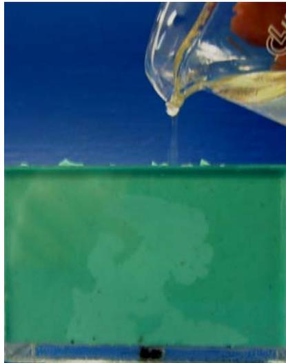
Figura. 9 Resina fotoelástica, sendo vertida no interior do molde em negativo.
