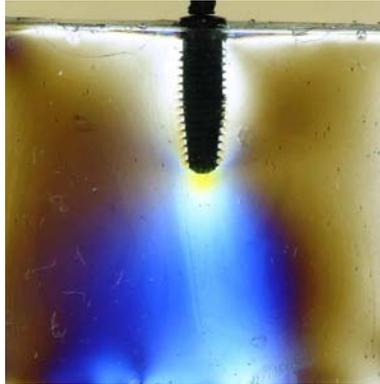
Figura. 15 Teste fotoelástica implante Master Conect Cônico® Submetido a carga vertical.
