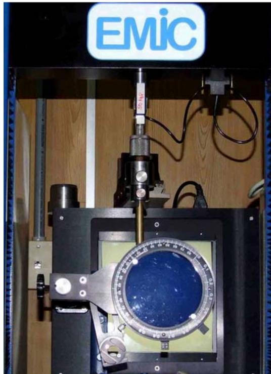
Figura. 3 Observe se o filtro óptico, a fonte luminosa, posteriormente, e o mecanismo de aplicação de cargas- EMIC.
