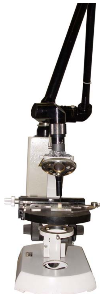
Figura 2. Laser de CO 2 acoplado ao microscópio para varredura da área de esmalte.
