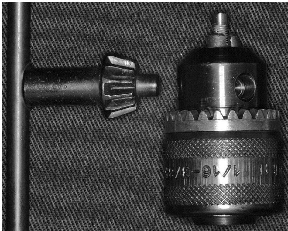
Figura 9 - Pinça com mandril, utilizada para a apreensão dos implantes durante a inoculação do microorganismo e instalação do conector protético.
