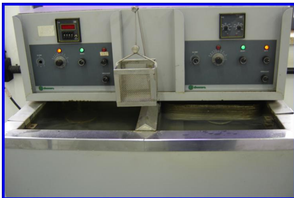
Figura 9 – Aparelho de termociclagem.
