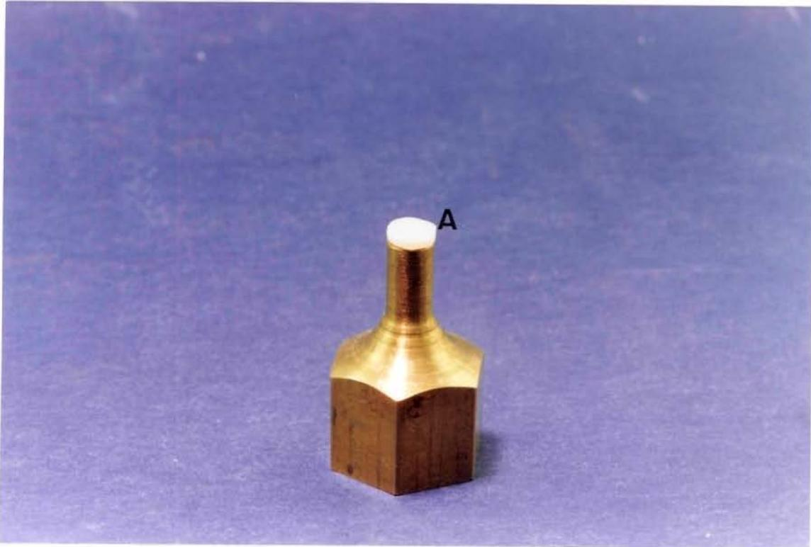
**Figura 2** - Fotografia do dispositivo metálico utilizado para fixar a amostra (A).
