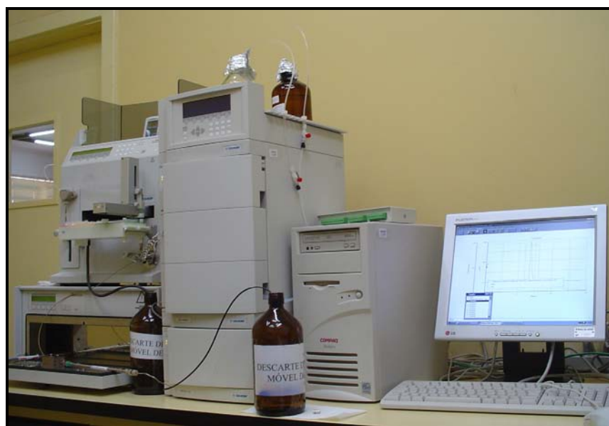
Fig. 9. Aparelho de Cromatografia Líquida de Alta Performance utilizado no ensaio incorporação dos agentes antifúngicos em resina acrílica.
