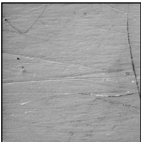
Fig. 30. Amostra representativa de resina acrílica polimerizada em banho de água após tratamento de superfície de 14 dias com água destilada ( Ra=0,12 \mu m ), em aumento de 500x.
