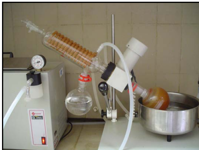
Fig. 3. Evaporador rotativo usado na concentração do EEP.
