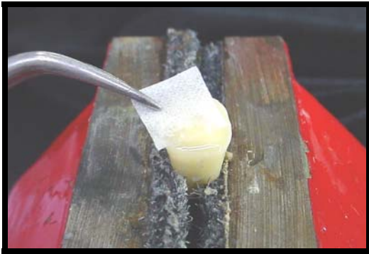
FIGURA 13 – Controle da umidade superficial com papel absorvente.
