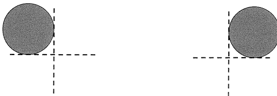
Figura 13 – Esquema de posicionamento do retículo óptico da lente ocular sobre os pontos referenciais.
