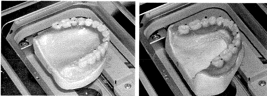
Figura 26- Próteses: superior e inferior polimerizadas posicionadas no microscópio mensurador linear Olympus STM.
