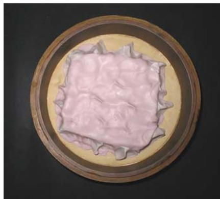
Figura 4.10 - Camada de silicone sobre as matrizes
