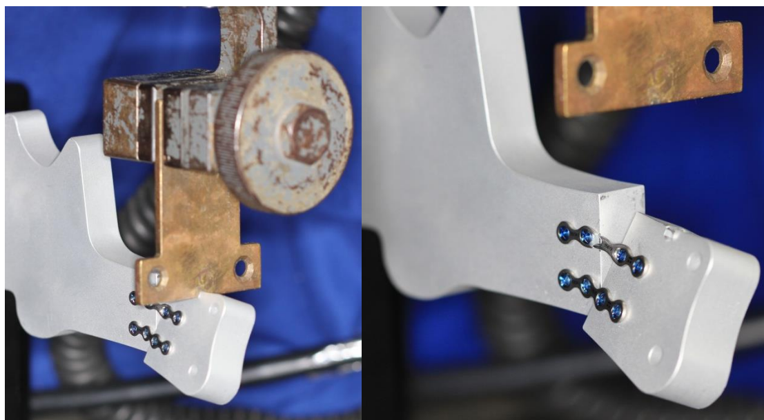
Figura 17. Incidência da carga axial no sulco em região anterior de mandíbula no grupo I com marca Tóride® até a fratura do material.
