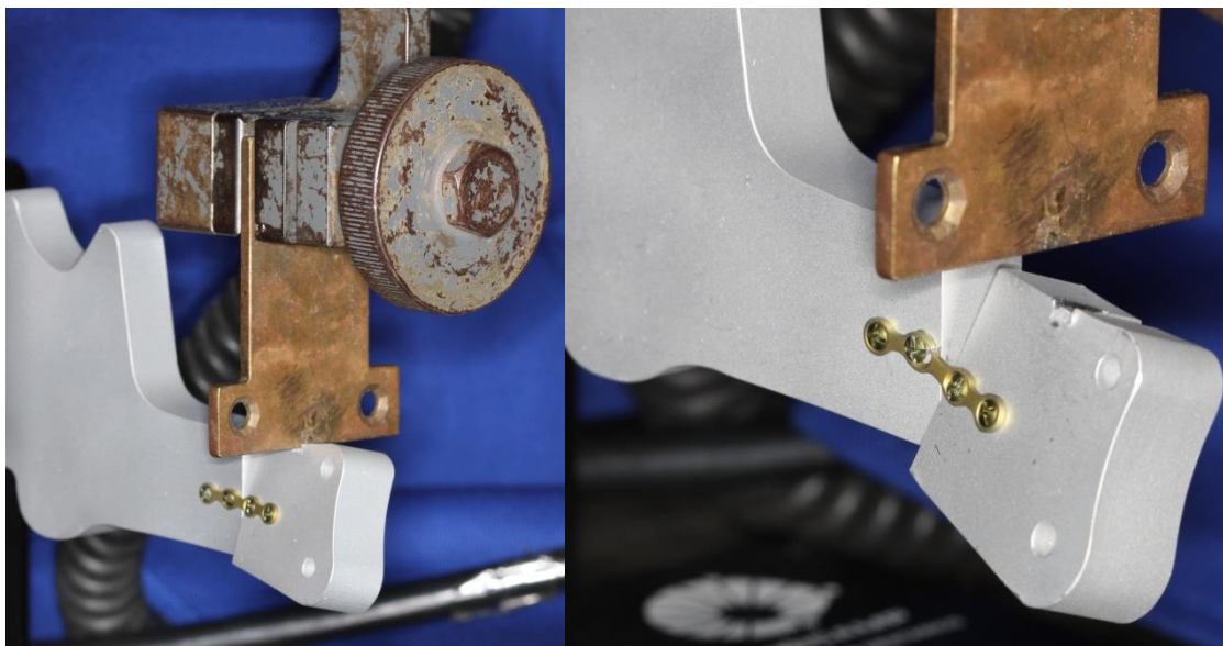
Figura 20. Incidência da carga axial no sulco em região anterior de mandíbula no grupo II da marca Traumecc ® até a fratura do material de fixação.
