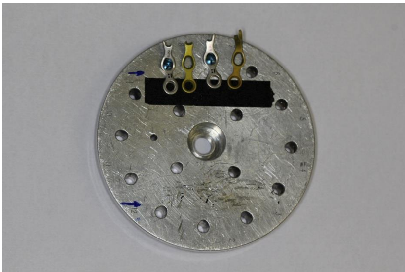
Figura 23. Amostras de cada empresa e grupo do estudo posicionadas no porta-amstras através de fita de carbono.
