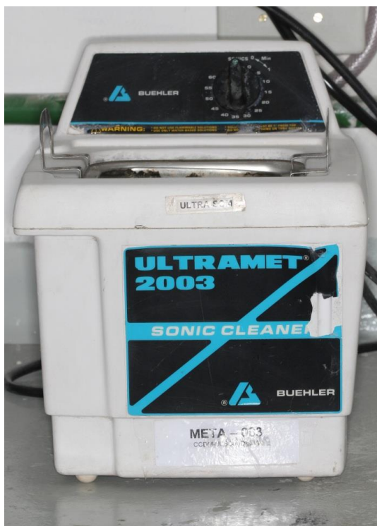
Figura 21. Máquina de ultrassom Ultramet 2003 Sonic Cleaner Buehler® para remoção de impurezas superficiais das amostras.
