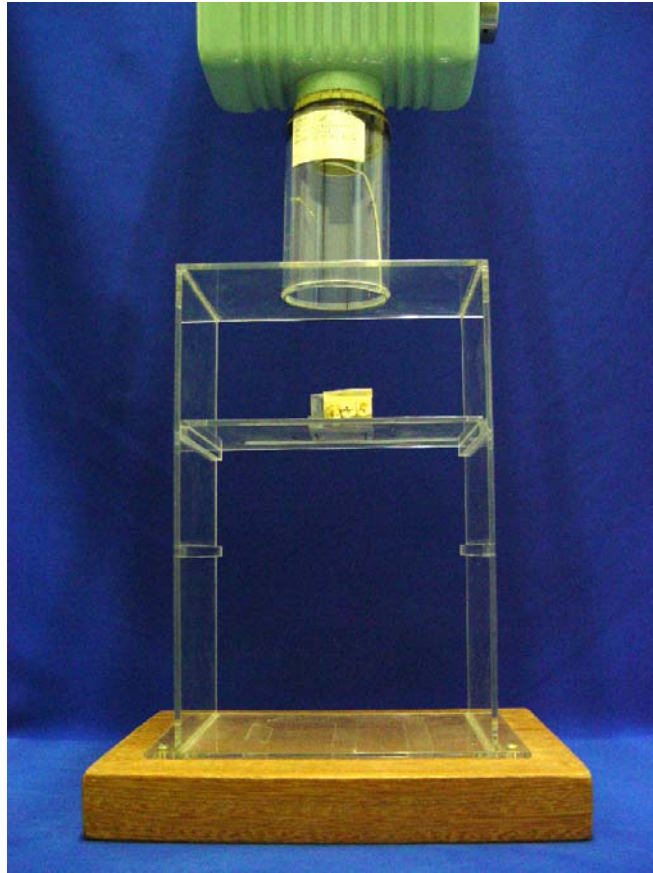
FIGURA 6 – Posicionador utilizado para padronização das exposições radiográficas
