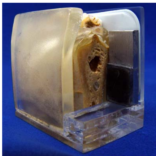
FIGURA 4 – Simulador e escala de densidade posicionados para exposição radiográfica
