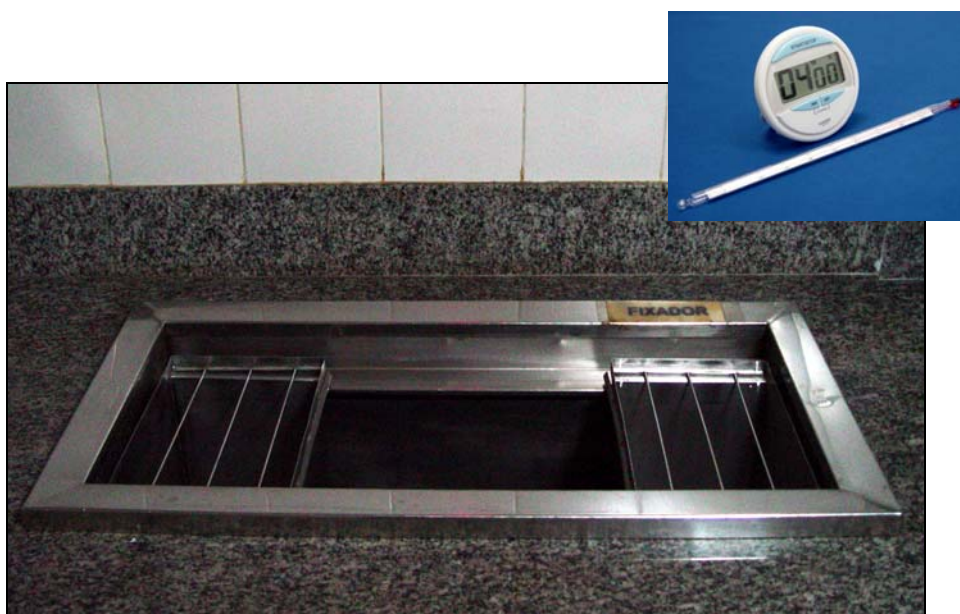
FIGURA 10 – Tanques para processamento manual. No detalhe: cronômetro digital e termômetro utilizados para método temperatura/tempo
