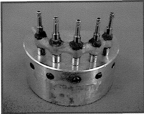
**Figura 17:** Cilindros unidos com resina acrílica
