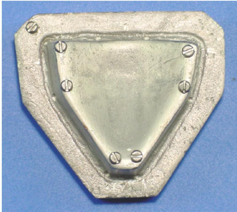
Figura 1- Matriz de alumínio com os sete parafusos em posição
