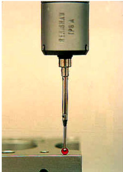
Figura 5- Sensor Eletrônico – Apalpador
