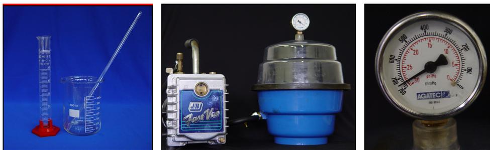
Figura 5. Utensílios utilizados para dosagem e manipulação da resina fotoelástica; A. Becker, proveta e bastão de vidro; B. Bomba e câmara para vácuo para remoção de bolhas; C. manômetro.
