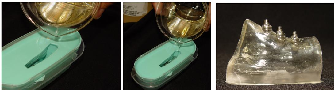
Figura 6A e B. Vazamento da resina fotoelástica; C. Modelo fotoelástico confeccionado.
