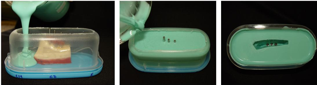
Figura 3A e B. Preenchimento do recipiente com silicone de duplicação; C. Molde após o prazo de cura e remoção da matriz.
