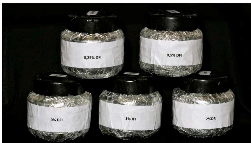
Figura 2 – Potes de vidro, contendo os cimentos experimentais, vedados contra a passagem de luz.
