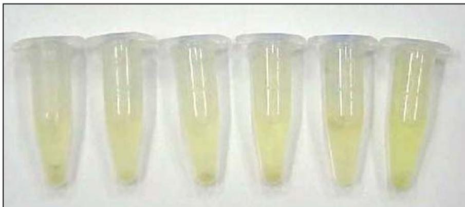
**Figura 3** - reação enzimática colorimétrica do substrato N-benzoyl-L-arginine-p-nitroanilide (BAPNA).
