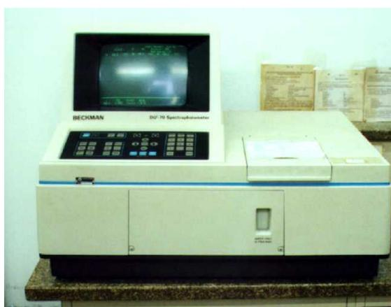
**Figura 6** – aparelho espectrofotômetro para medição da absorbância de cada amostra em comprimento de onda de 405nm.
