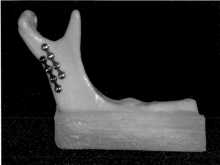
FIGURA 10 - Base de resina para fixação no suporte, vista lateral.
