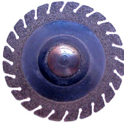
Figura 7 – Disco diamantado serrilhado.
