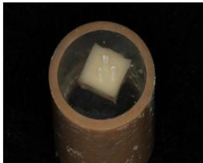
Figura 12: Cilindros de cimento sobre a superfície da cerâmica embutida no cilindro de PVC.
