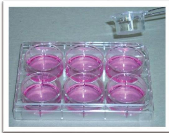
Figura 01 - Ilustração de um *insert*
