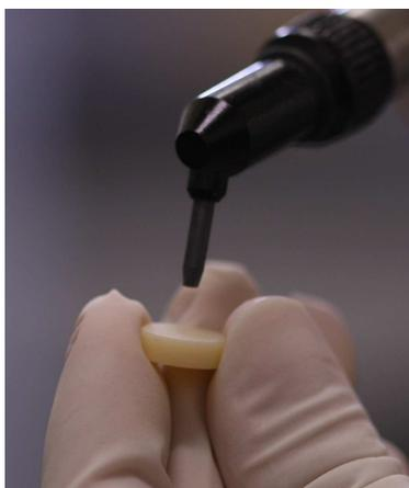
Figura 3: Jateamento da superfície do disco de resina composta à base de silorano com partículas de óxido de alumínio de  $50\mu\text{m}$ .
