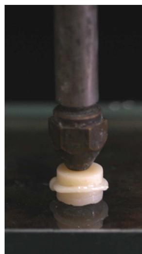
Figura 15: conjunto disco/cimento/disco no dispositivo estático de carga.
