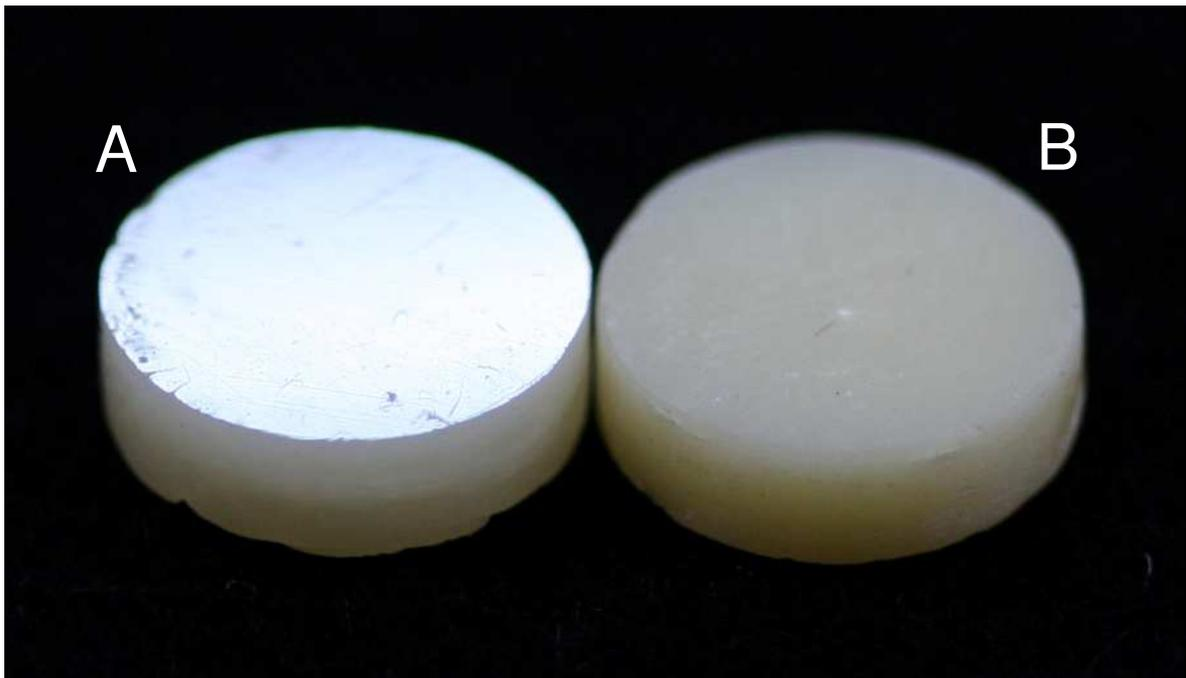
Figura 10: Superfícies de discos de resina composta à base de silorano antes (A) e após (B) serem submetidas a jatos de partículas de óxido de alumínio.
