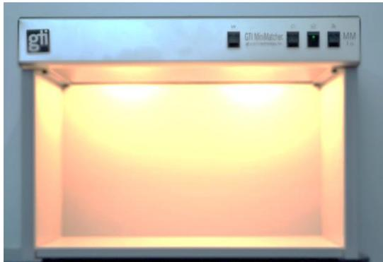
**Figura 19**– Cabine de luz utilizada para análise das amostras (GTI Minimatcher).
