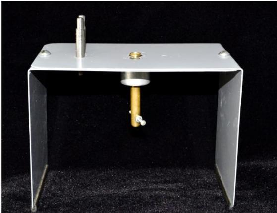
**Figura 16** – Dispositivo para posicionamento da amostra.
