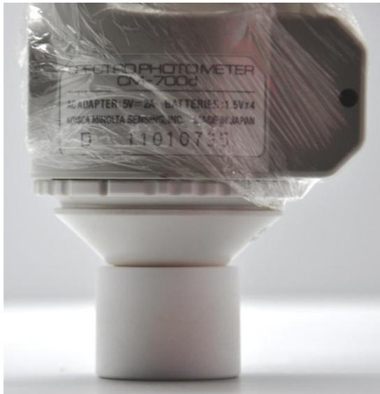
**Figura 21** – Acoplamento do espectrofotômetro no porta-amostra.
