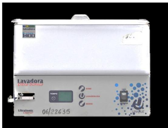
**Figura 12** - Ultrassom utilizado para limpeza das amostras.
