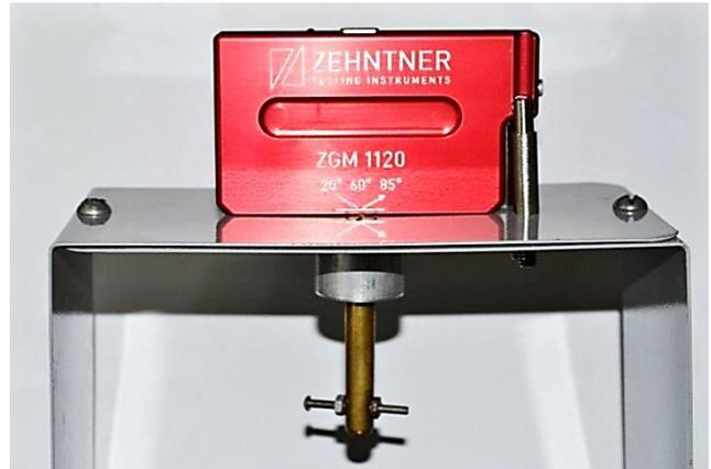
**Figura 17** – Medidor de brilho posicionado sobre o dispositivo/amostra.
