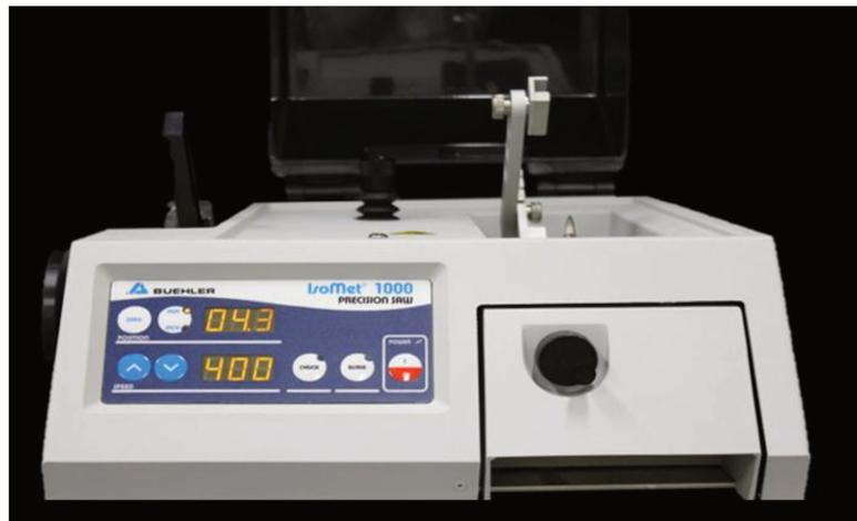
Figura 1 - Cortadeira metalográfica (Isomet 1000, Buehler)
